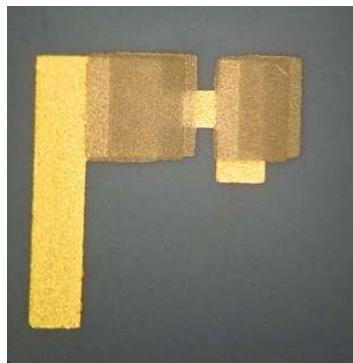
FIGURE 4.11: BACK SIDE SERIES CAP PAD
