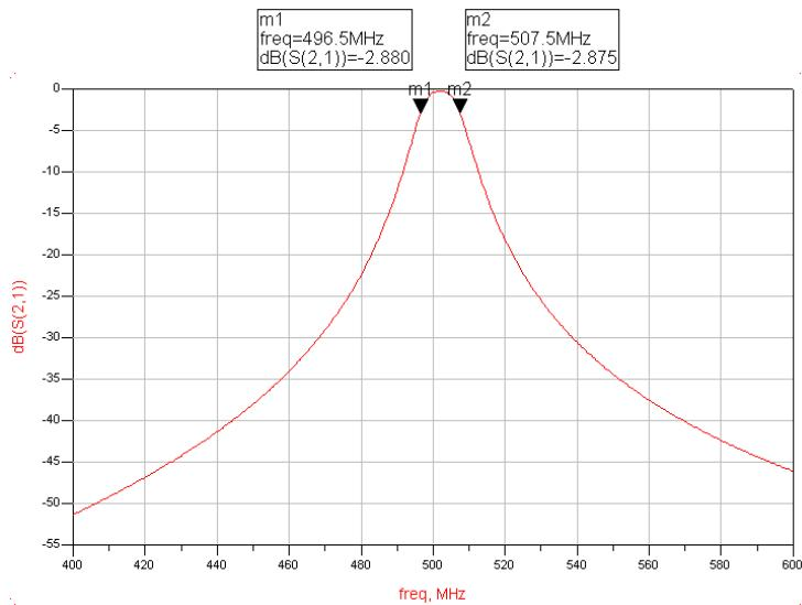
FIGURE 7.4: SIMULATION OF THE FILTER
