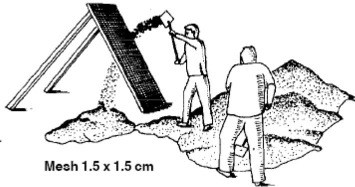
**FIG. 19 SIEVING & PULVERIZING**
