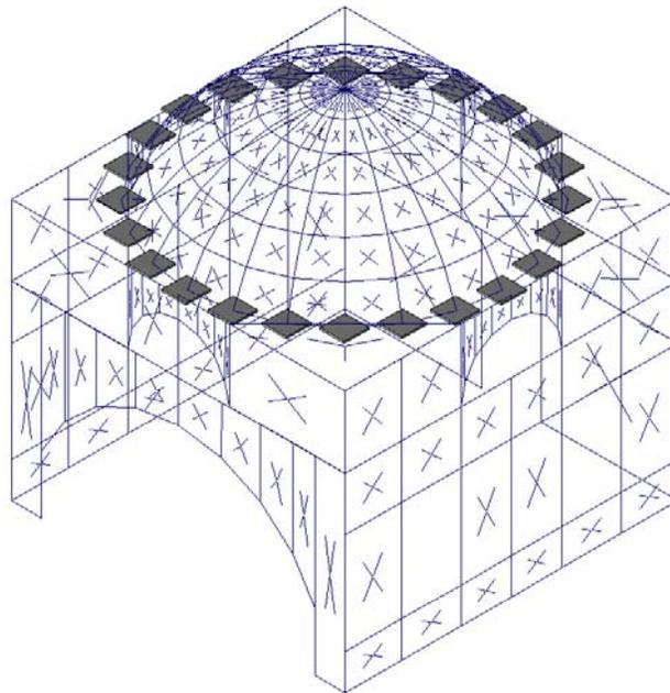
**FIG. 85** RIGID LINKS BETWEEN THE DOME AND THE WALLS
