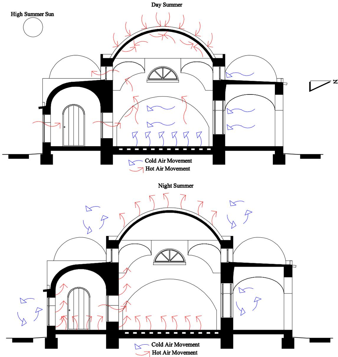
**FIG. 28 PASSIVE COOLING**
