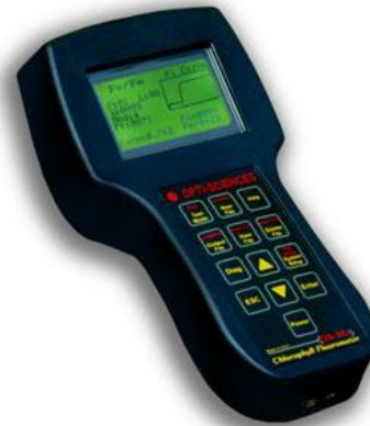
(D) Chlorophyll Fluorometer (To estimate maximum quantum yield of the photosystem II)
