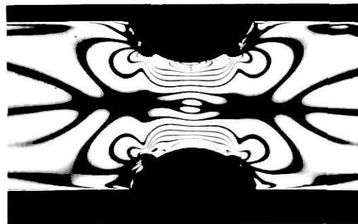
(d) 6/64 inch radius Notches, Load 15 Divisions
