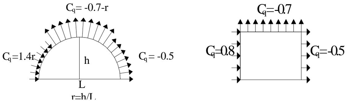
**FIG. 90** C<sub>q</sub> FOR DOME SHAPES
