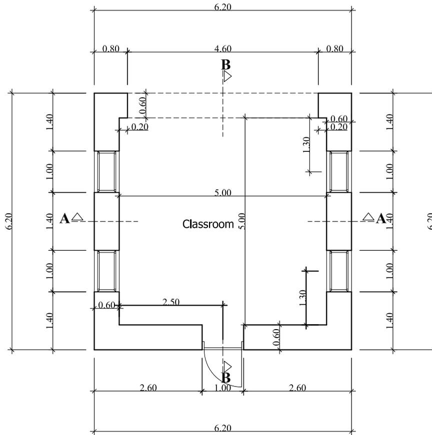
**FIG. 33 SINGLE CELL DIMENSIONAL PLAN**
