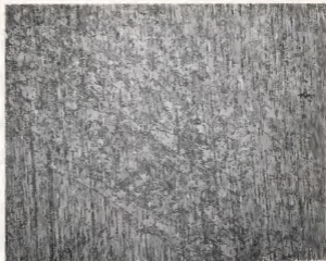
Fig. 19. Magnesium calcium alloy. 0.1 per cent Ca. X 100.
