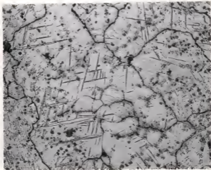
Fig. 22. Magnesium calcium alloy. 1.0 per cent Ca. X 100.
