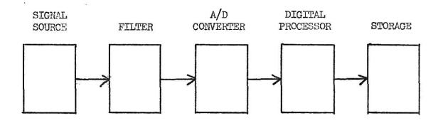
SAMPLE HARDMANE CONFIGURATION -- VOLTAGE DIGITAL MEASUREMENT SYSTEM
