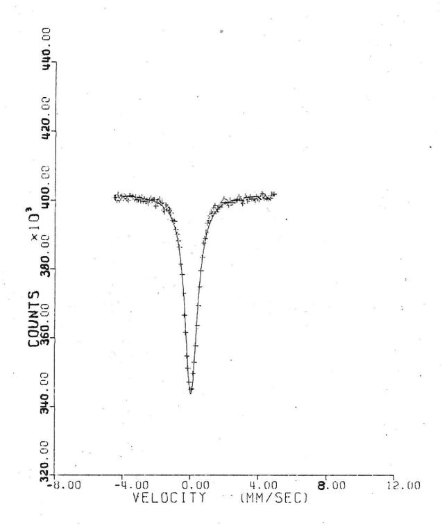
Figure VI. Source - <sup>57</sup>Fe(p,p) <sup>57</sup>Fe; Absorber - ferrocyanide.
